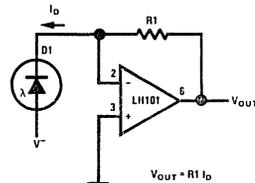
FIGURE 15. Photodiode Amplifier
