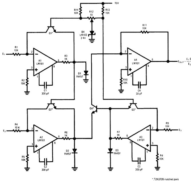
FIGURE 10. Analog Multiplier/Divider
