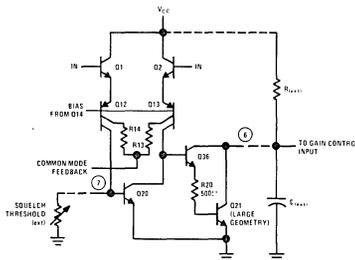
FIGURE 8. LM170 Squelch Detector
