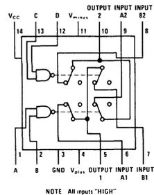
FIGURE 2. LH0014 and LH0019 DTL-TTL Compatible MOS Analog Switches
